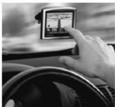
*Veículo equipado com GPS de bordo e um software com mapas, que indicam a posição do veículo e o caminho a percorrer até um determinado ponto.*
